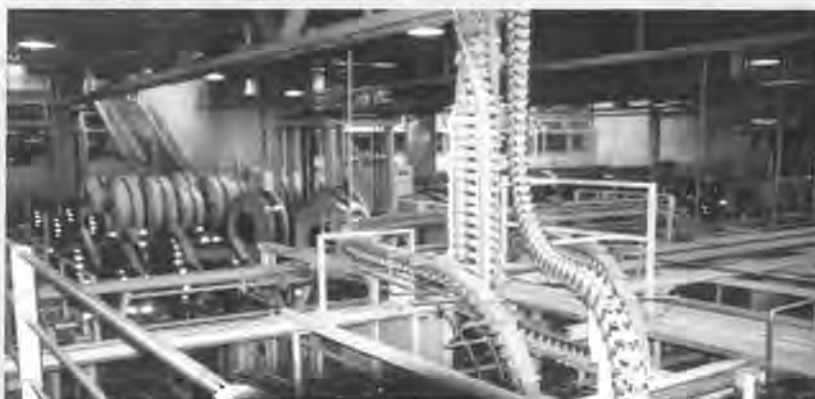
Weitgehend automatisiert ist der Weg des Zeitungspapiers durch die Rotation hin zum Versand.
